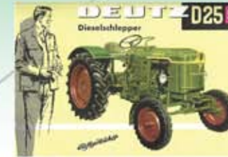
Introduction du D25 la nouvelle génération de moteurs FL 712 avec des puissances de 13 à 52 cv.
